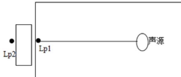
图 4-1 室内声源等效为室外声源图例
