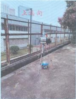
厂界废气无组织排放上风向参照点 G1
