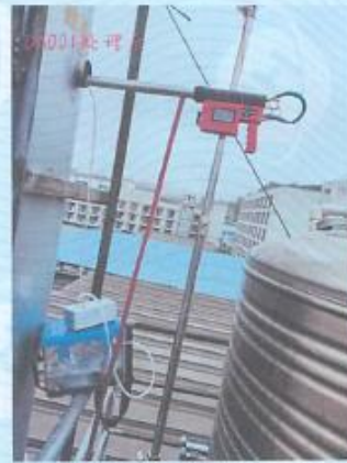
DA001 注塑废气处理后检测口 G8
