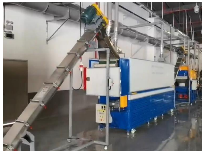
项目烘干机（输送带进入烘干机到烘干机出去都是全密闭）
